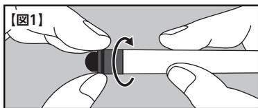
軸を固定した状態でタッチゴムカバーを回し外してください。【図1】
