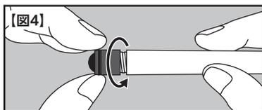
【図1】と逆の手順でタッチゴムカバーを取り付けてください。【図4】
