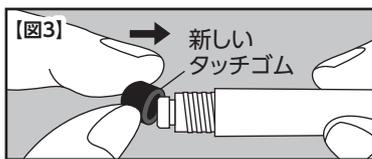
新しいタッチゴムを軸先端にかぶせるようにしっかり取り付けてください。【図3】
